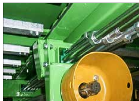
Wał napędowy i zabezpieczone przewody hydrauliczne
